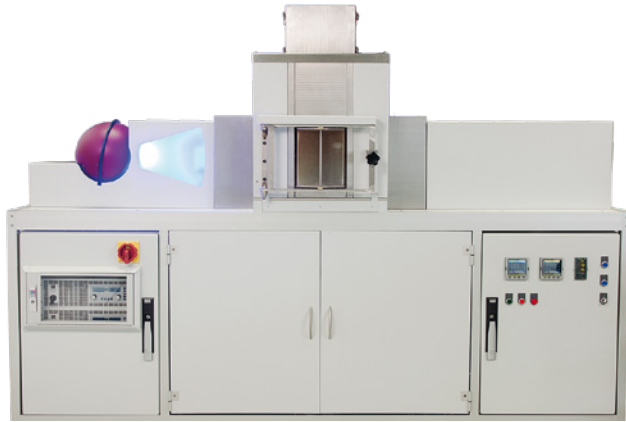
ThermoOptische Messanlage TOM_air
