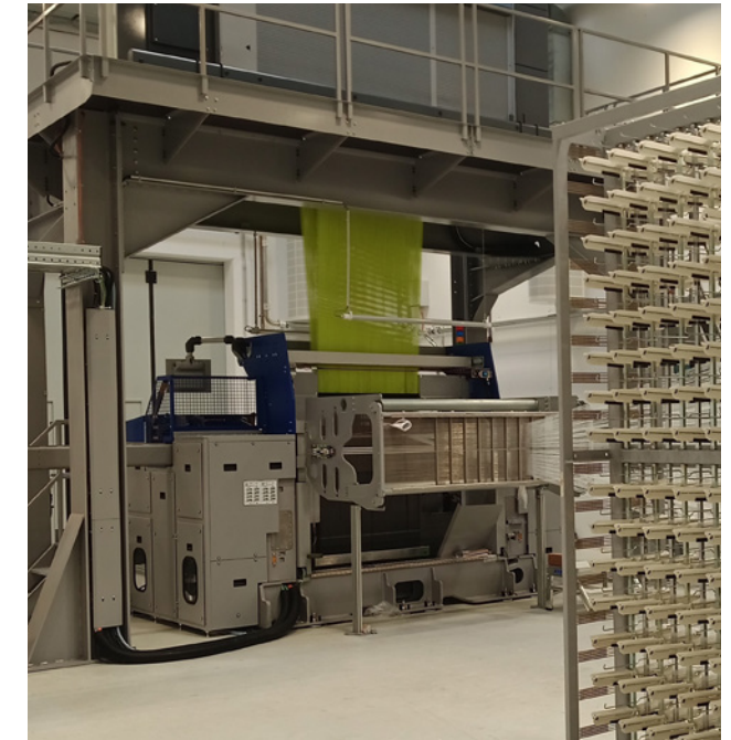
Doppelgreiferwebmaschine mit Einzelfadensteuerung
